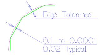
Figure 17 - Edge tolerance explanation
